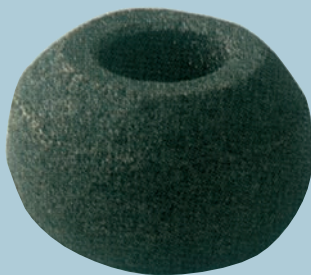
NTN BEARPHITE graphite skeleton 上記軸受の溶解後のグラファイトスケルトン
